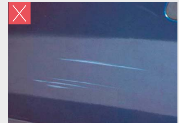
DELLEN, DIE AUSBEUL- UND LACKIERARBEITEN ERFORDERLICH MACHEN
