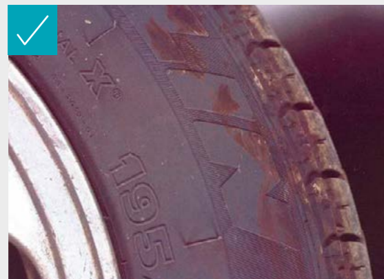
ABSCHUEURUNG AN DER SEITENWAND KANN DURCH NORMALE WARTUNG BEREINIGT WERDEN
