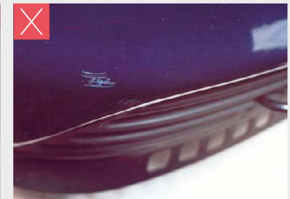
KRATZER AM STOSSFÄNGER BIS AUF DEN GRUNDWERKSTOFF
