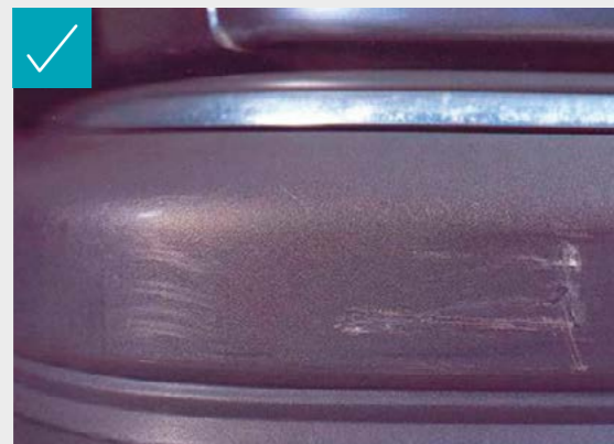
LEICHTER ABRIB BEI NICHT LACKIERTEM STOSSFÄNGER (ODER SCHUTZLEISTE), VORAUSGESETZT, ER KANN DURCH NORMALE REPARATUR ODER ÜBERHOLUNG OHNE AUSTAUSCH BEHOBEN WERDEN
