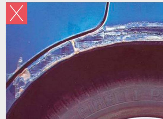
EIN EINZIGER KRATZER VON MEHR ALS 100 MM, DER EINE NEULACKIERUNG ERFORDERLICH MACHT ODER MEHR ALS EIN BLECH BETRIFFT
