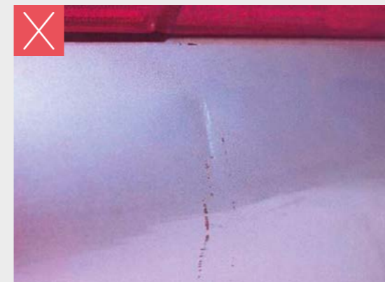
DELLE MIT EINEM DURCHMESSER VON MEHR ALS 30 MM
