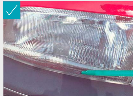
STREUSCHEIBE MIT GERINGFÜGIGER ABSPLITTERUNG IST AKZEPTABEL, FALLS ES SICH NICHT NEGATIV AUF DAS ERSCHEINUNGSBILD DES FAHRZEUGS ODER DEN WIRKUNGSGRAD DER LEUCHTE AUSWIRKT
