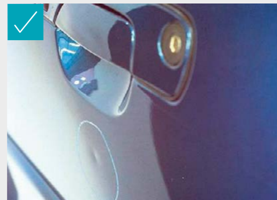
MAX. DREI DELLEN MIT EINEM DURCHMESSER VON NICHT MEHR ALS 30 MM, DIE KEINE NEULACKIERUNG ERFORDERLICH MACHEN
