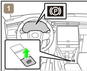
1) Blockieren Sie die Räder und ziehen Sie die Feststellbremse an.
