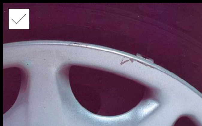
Geringfügige Schrammen mit einer Länge von weniger als 80 mm sowie leichte Beschädigung oder leichter Abrieb an Felge/Radzierblende, bei nur einem Schaden pro Rad
