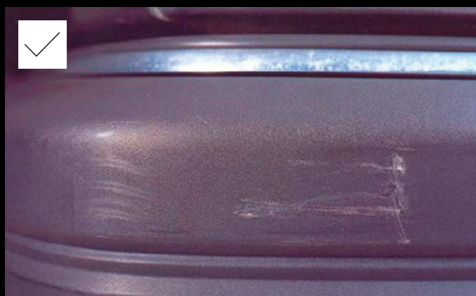
Leichter Abrieb bei nicht lackiertem Stoßfänger (oder nicht lackierter Schutzleiste), vorausgesetzt, er kann durch normale Reparatur oder Überholung ohne Austausch behoben werden
