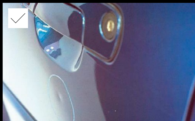
Max. drei Dellen mit einem Durchmesser von nicht mehr als 30 mm, die keine Neulackierung erforderlich machen
