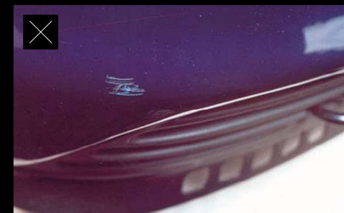
Kratzer am Stoßfänger bis auf den Grundwerkstoff
