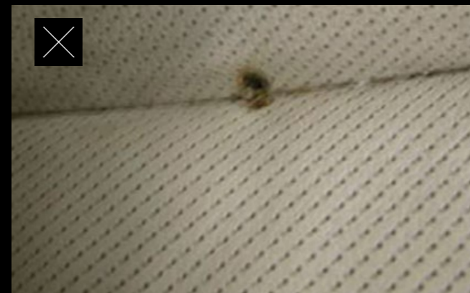
Brandlöcher in der Verkleidung, den Sitzbezügen, dem Dachhimmel und dem Bodenbelag
