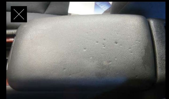
Ausgeprägte Abnutzungen sowie Risse, Schnitte und Löcher in Ausstattungselementen des Innenraums
