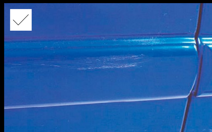
Leichter Abrieb, der keine Neulackierung erforderlich macht, über eine Länge von weniger als 100 mm
