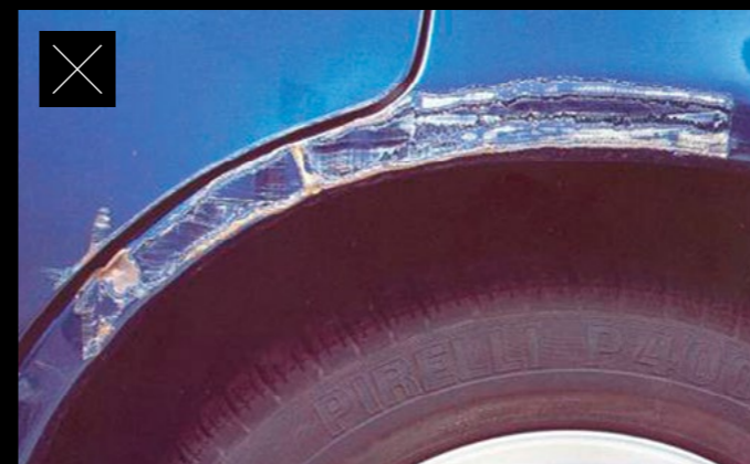
Ein einziger Kratzer von mehr als 100 mm, der eine Neulackierung erforderlich macht oder mehr als ein Blech betrifft
